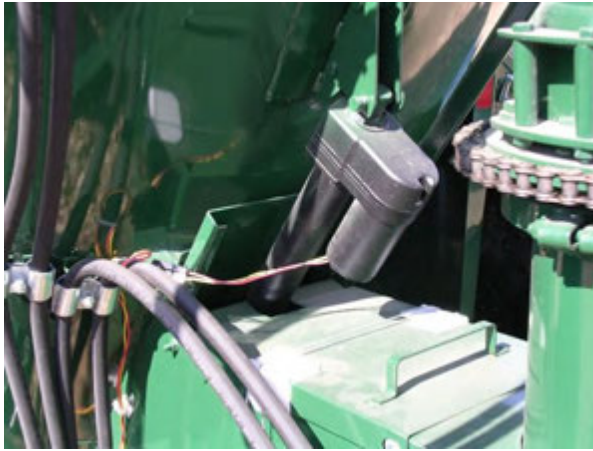
Figure 99 - Discharge Door Actuator.
