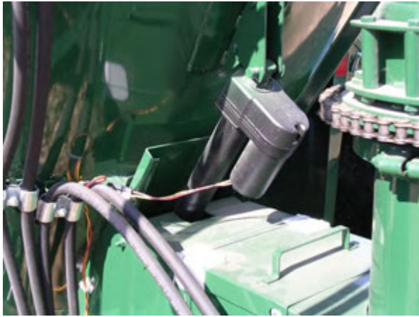
Figure 99 - Discharge Door Actuator.
